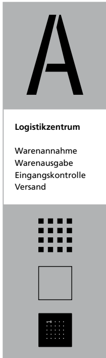
Montageebene: Schwarz Funktionsebene: Edelstahl gebürstet Beschriftung: Bedruckte Klebefolie Text schwarz
