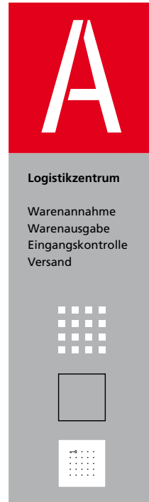
Montageebene: Weiß Funktionsebene: Edelstahl gebürstet, Kopfpaneel Edelstahl rot lackiert Beschriftung: Folienschrift oder Siebdruck
